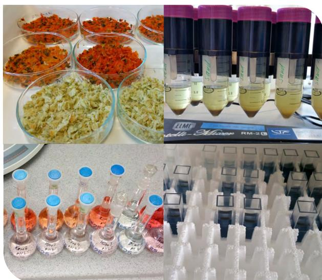
**Abbildung 3:** Typischer chemischer Analysenprozess (v.l.o.n.r.u.: Fruchtpürees, Extraktion, Extrakte, Messlösungen für Spektralphotometrie).
