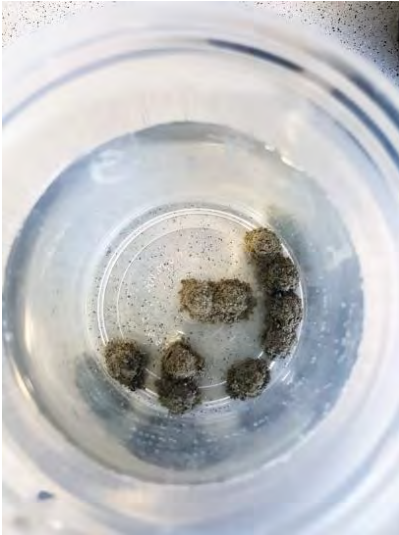
Abb. 2: Grünschnitt-Pellets im Hydrokultur-Versuchsgefäß (Aufsicht)
