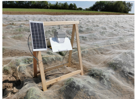
Abb. 5: Falle mit integrierter Kamera und Solarmodul zur Überwachung des Kohlmotten-Auftretens.
