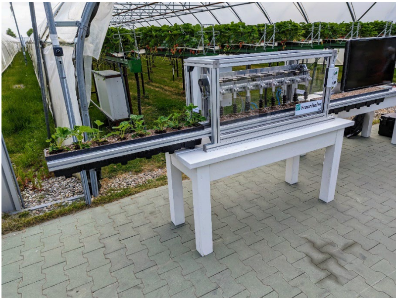
Abb. 4: Ein Prototyp des Fraunhofer IGP unterstützte bereits in diesem Jahr das Bepflanzen der Stellagen. Die bisher ausschließlich händische Arbeit wird durch einen automatischen Bohrprozess ergänzt.
