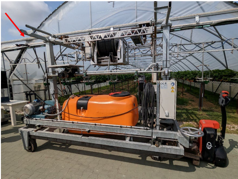
Abb. 3: Mittels Bildern von speziellen Multi- und Hyperspektralkameras (roter Pfeil am oberen linken Bildrand) gelingt es, erste Krankheitssymptome frühzeitig zu erkennen. Infizierte Pflanzen können selektiv behandelt werden, bevor es zu einer flächendeckenden Ausbreitung im gesamten Bestand kommt.
