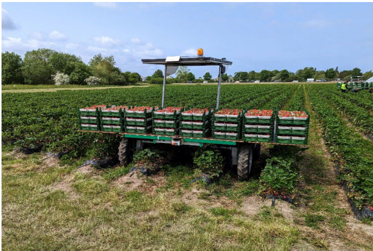
Abb. 5: Der Transportroboter der Ant Robotics GmbH folgt kamera- und sensorgestützt den Erntehelfern auf dem Feld autonom entlang der Pflanzreihen. Die körperliche Belastung der Pflücker wird deutlich verringert und ihre Leistung erhöht sich um bis zu 35 Prozent.
