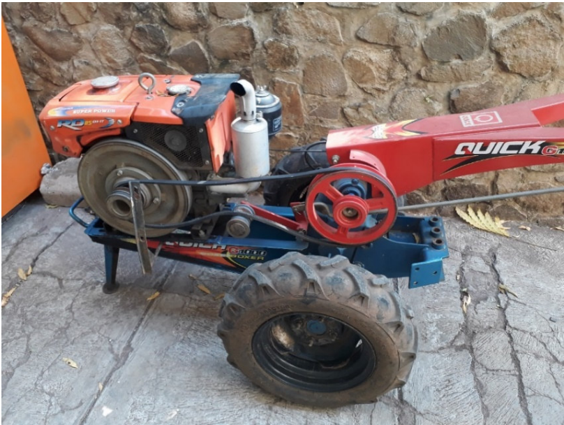
Abb. 2: „Japanese Cow“, Einachsschlepper mit demontierbarem Schwungradmotor und einfacher Kraftübertragung mit Keilriemen
