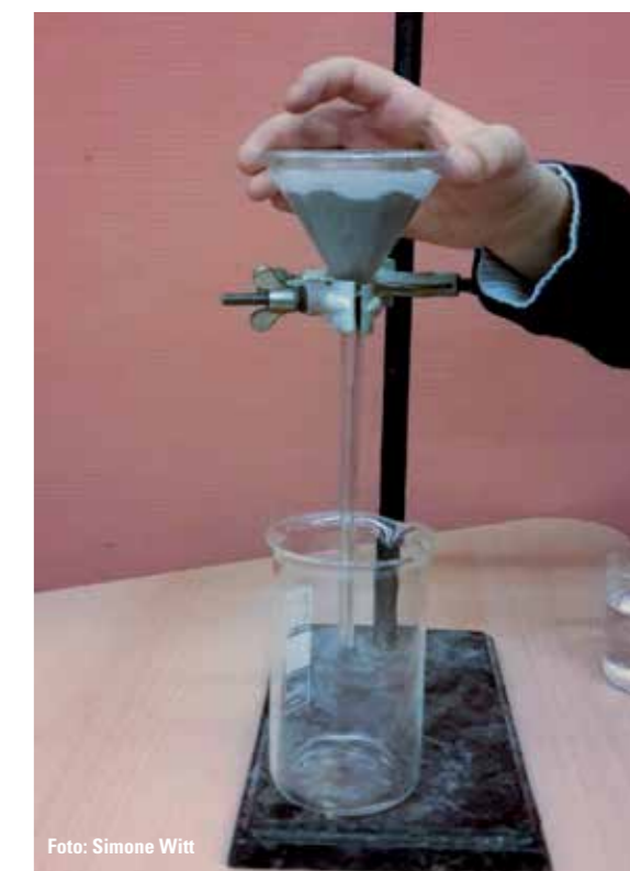
Abbildung 3: Versuch zur Wasserspeicherfähigkeit des Bodens
