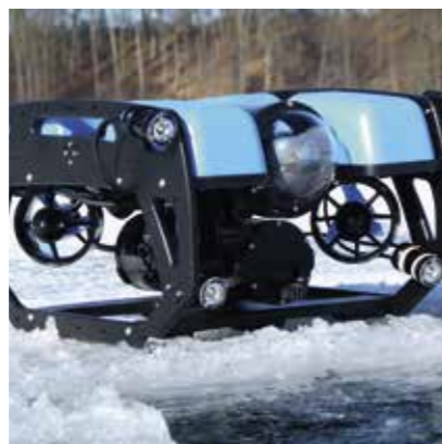
Abb. 2: Unterwasserroboter (ROV) vor dem Einsatz
