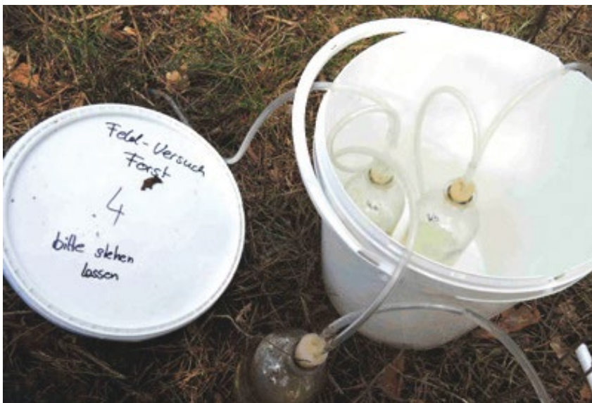
Abb. 4: Entnahme von Bodenwasser mittels Lysimeterkerzen
