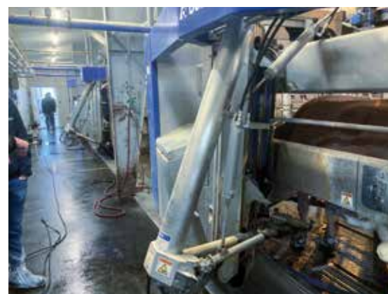
Eine von zwei Stationen mit jeweils 3 VMS 300 Melkroboter
