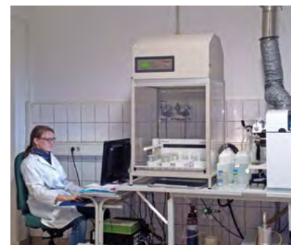
Abb. 3: Spuremetallanalyse mit ICP-MS (Massenspektrometrie mit induktiv gekoppeltem Plasma)
