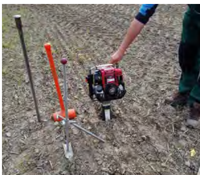
Abb. 1: Equipment für die N_{\min} -Probenahme (Bohrstock, Ziehgerät, Schlaghammer und Bohrhämmer)
