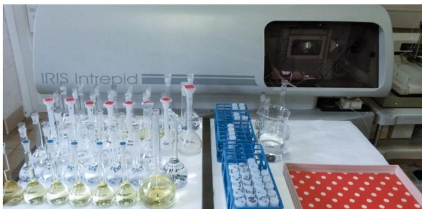
**Massenspektrometrie mit induktiv gekoppeltem Plasma (ICP) zur Schwermetallbestimmung**
