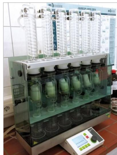
**Automatisierte Soxhlett-Anlage für die Rohfettbestimmung**
