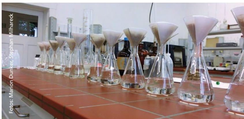
**Filtration der Proben als Teilschritt der Rohfettanalyse**
