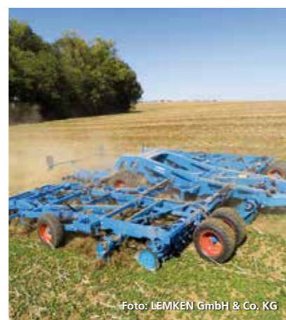
Abbildung 2: Zweireihige Kurzscheibenegge mit dreireihiger Walze, Koralin
