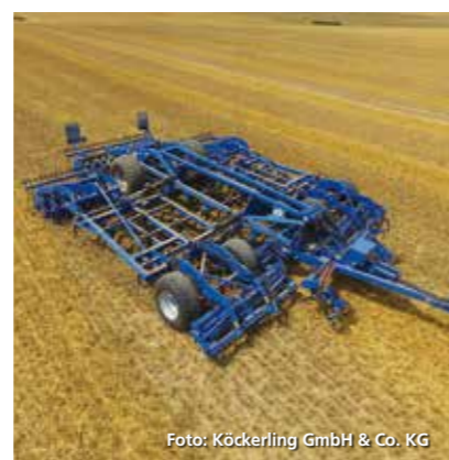
Abbildung 4: Sechsbalkiger Grubber, Allrounder flatline
